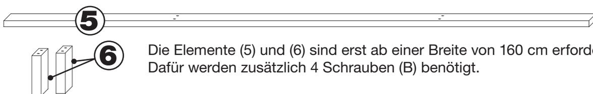
Die Elemente (5) und (6) sind erst ab einer Breite von 160 cm erforderlich. Dafür werden zusätzlich 4 Schrauben (B) benötigt.
